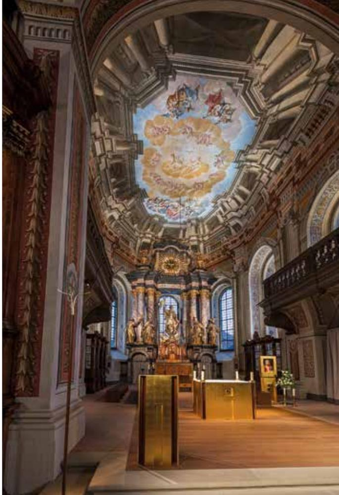
die Entscheidung. Dieses einzig sichtbare Element der Beleuchtungstechnik zeigt klar seine Funktion, technisch-modern und so filigran wie möglich. Nur die Oberfläche der 6x6cm starken Stahlsäulen hat mittels handgestrichenem Eisenglimmer-Dickschichtlack keine Industrieanmutung erhalten, denn »undenkbar wäre ein Pulverlack vor so viel genialer Malerei«, meint Stephan Meyer.
